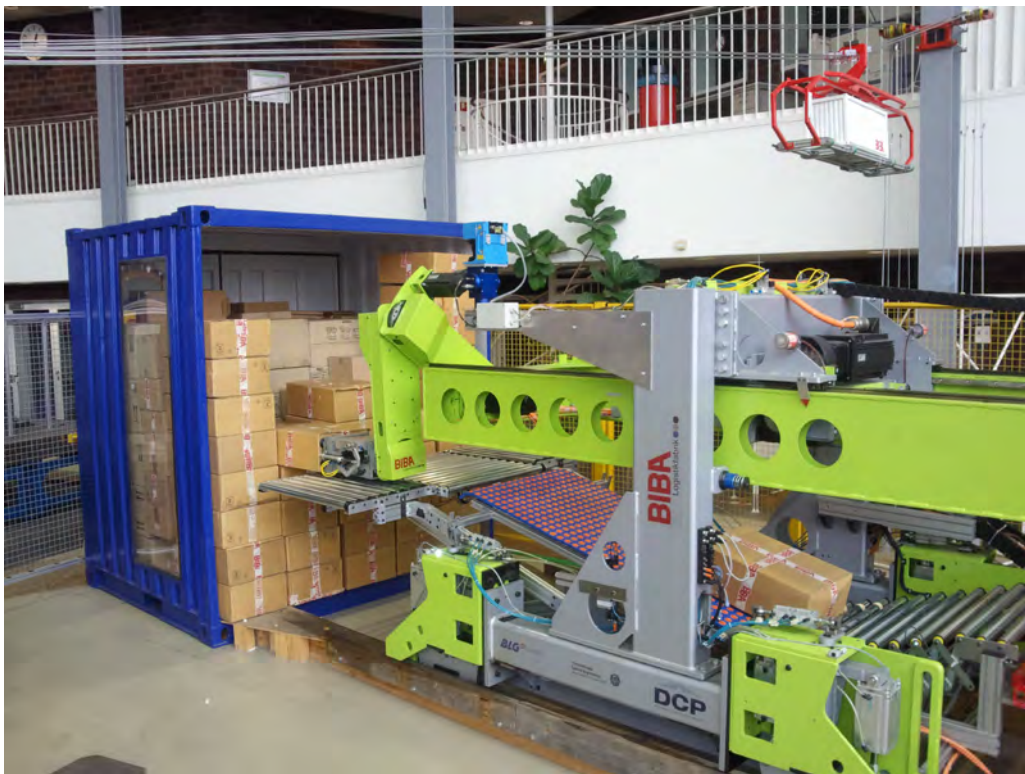
Abbildung 1.1: Paketroboter beim Entladen eines Containers (BIBA, 2011)
